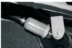
(Figura A - Schimbarea filtrului de combustibil, situat în spatele panoului de acces frontal, o dată pe an)
